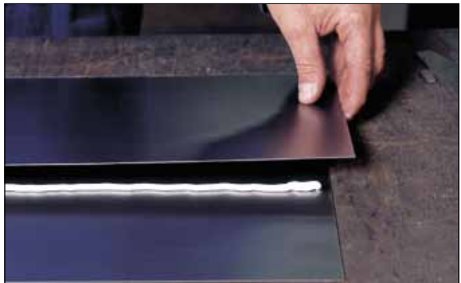
Verkleben von Anschlussblechen im Bereich Großküchenfertigung
