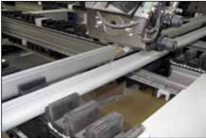
Speed-Flex - Automatisierter Auftrag bei der Fertigung von Türen für Kühlschränke in Supermärkten
