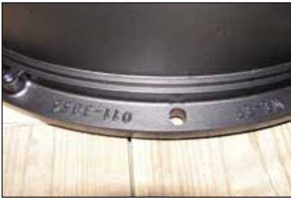
Flex 310 M HT 200 - Abdichten eines Fügespalts mit anschließender Pulverbeschichtung
