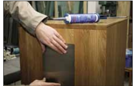
Speed-Flex - Verkleben von Edelstahlblechen auf Holz
