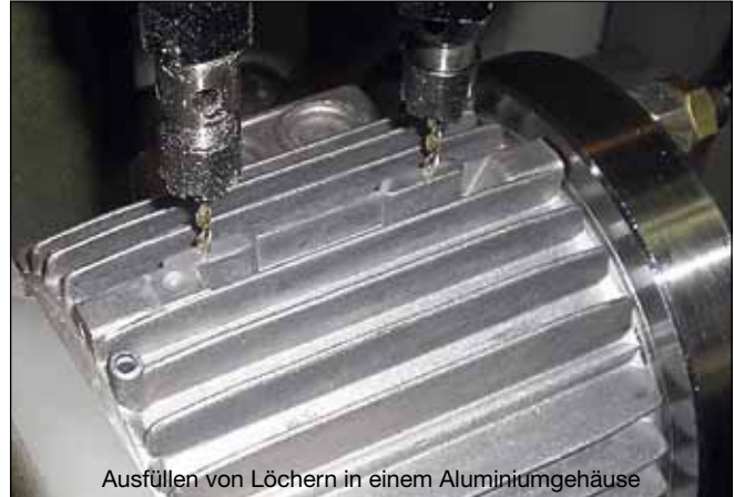
Ausfüllen von Löchern in einem Aluminiumgehäuse
