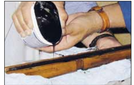
WEICON WR - Einbetten eines Gewehrlaues in den Gewehrschaft
