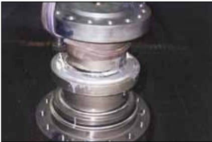
WEIDLING C - Reparatur einer Kurbelwelle
