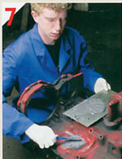
Das fertig angerührte und gemischte Flüssigmetall wird nun großflächig auf den defekten Bereich aufgetragen.
