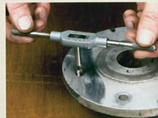
Eine mit Trennmittel eingesprühte Schraube wird in das noch weiche Flüssigmetall eingedreht und verbleibt dort bis zum vollständigen Aushärten.
