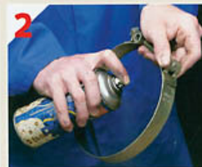
...damit das Flüssigmetall nicht an der Schelle anhaftet, wird diese zuvor mit einem Trennspray (z.B. Schweiß-Schutzspray) eingesprüht.
