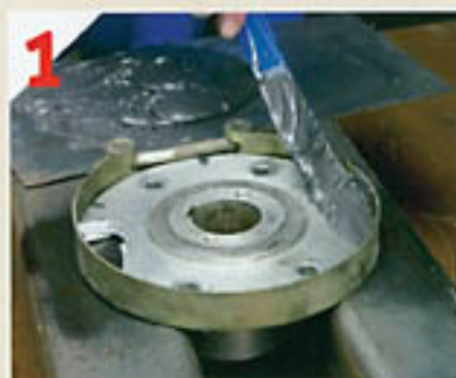
Um den Teilbereich neu aufbauen zu können, wird der ganze Flansch mit einer großen Schraubschelle eingefasst (sozusagen „eingeschalt“).
