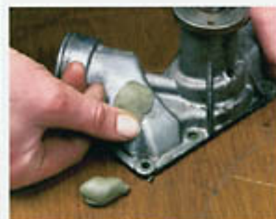
Die knetfähige Masse wird auf den vorgeinigten Untergrund gedrückt.
