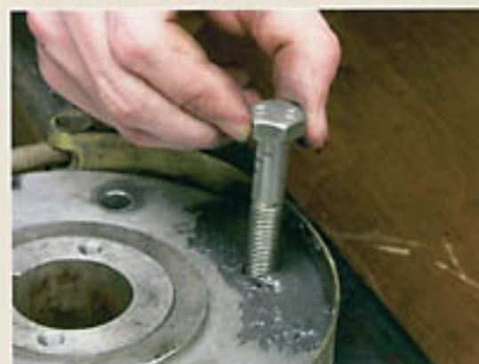
Eine mit Trennmittel eingesprühte Schraube wird in das noch weiche Flüssigmetall eingedreht und verbleibt dort bis zum vollständigen Aushärten.
