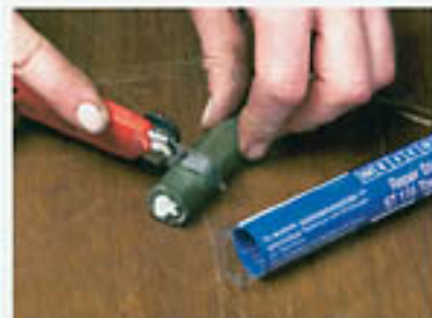
Von der Zweikomponenten-Stange wird ein passendes Stück abgeschnitten.
