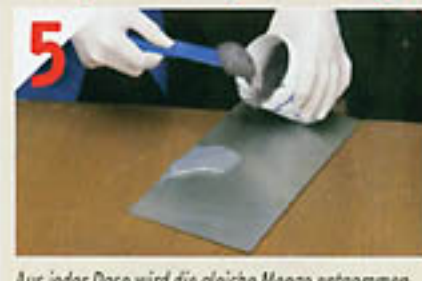
Aus jeder Dose wird die gleiche Menge entnommen und auf ein Blech gestrichen. Beachten Sie bitte immer das vorgeschriebene Mischungsverhältnis.
