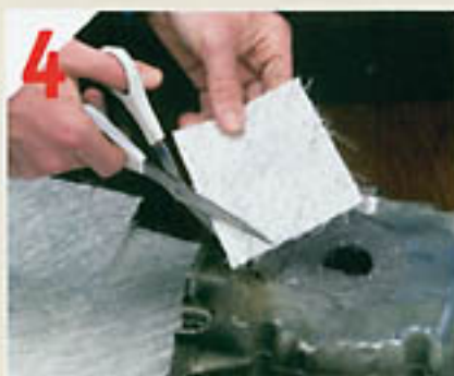
Ein Stück Glasfaser-Gewebematte wird in das noch frische Flüssigmetall gedrückt.
