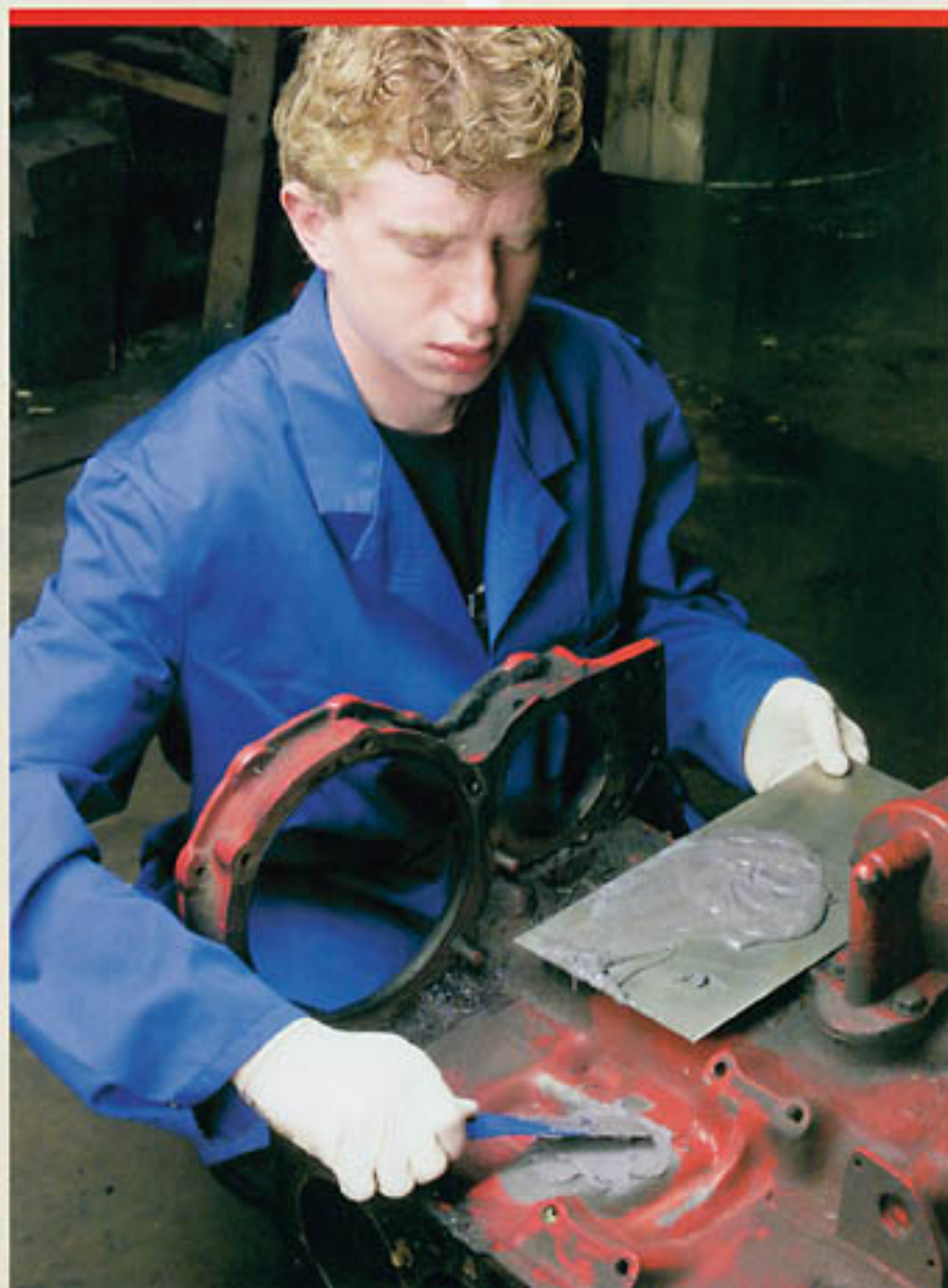
Die Behebung eines Frostschadens am Motorblock ist für Flüssigmetall eine der leichtesten Übungen.
