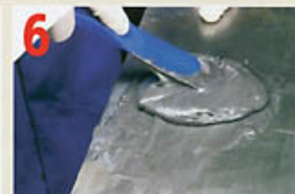
Die Komponenten werden so lange verrührt, bis sich eine homogene, graue Masse ergibt.
