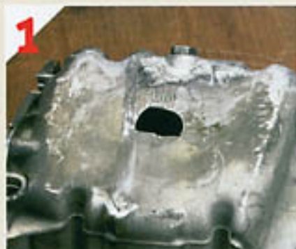
Im Boden der Ölwanne fehlt gleich ein ganzes Stück Material.
