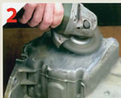
Der Bereich rund um den Defekt wird sorgfältig gereinigt.
