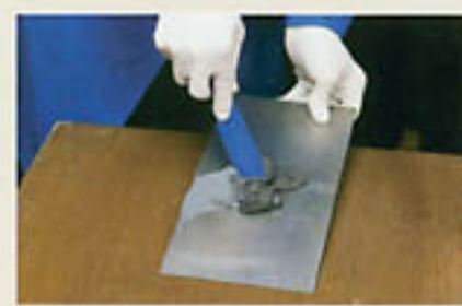
Am einfachsten lässt sich mit Flüssigmetall arbeiten, das im Verhältnis 1:1 gemischt wird.
