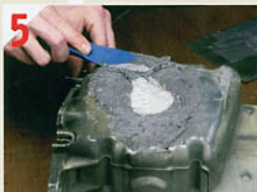
Ein Stück Glasfaser-Gewebematte wird in das noch frische Flüssigmetall gedrückt.
